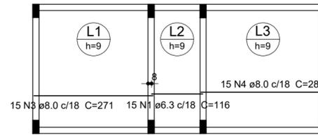
Armação positiva das lajes do pavimento FUNDO RES. (Eixo X)
